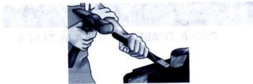
Рис. 3.1. Положение зубила при рубке
